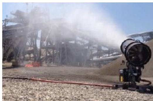
Le principe de barrières anti-poussières qui pourrait être mis en œuvre (Source : WeatherSolve Structures)
