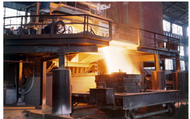
Figure 8. Four à arc électrique
